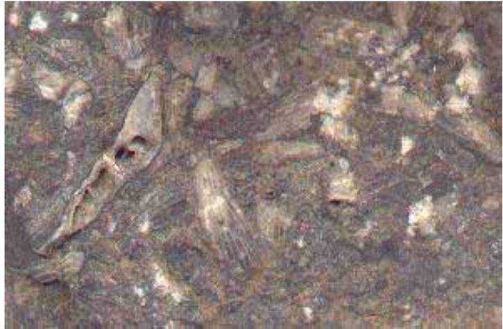
**1.4 Mármol.** Variedad cristalina y compacta de caliza metamórfica, que puede pulirse hasta obtener un gran brillo y se emplea sobre todo en la construcción y como material escultórico. Comercialmente, el término se amplía para incluir cualquier roca compuesta de carbonato de calcio que pueda pulirse, e incluye algunas calizas comunes; también incluye, en términos genéricos, piedras como el alabastro, la serpentina y, en ocasiones, el granito.
