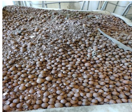
Foto 8. Bolas de acero utilizado para reducir el material triturado inicialmente (materia prima), las mismas se observaron fuera de uso.
