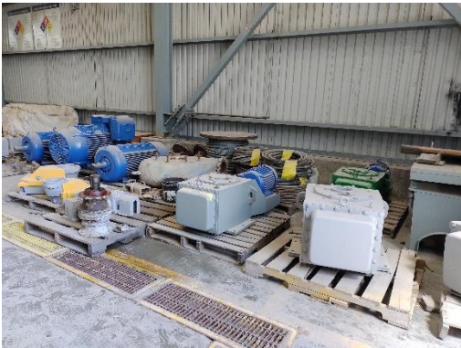
Foto 7. Equipo y materiales fuera de operación, contenido dentro de tarimas, para evitar el deterioro de los mismos.
