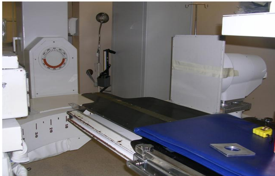
FIG. 38. Arreglo experimental para determinar el tamaño de campo a la entrada del receptor de imagen.
