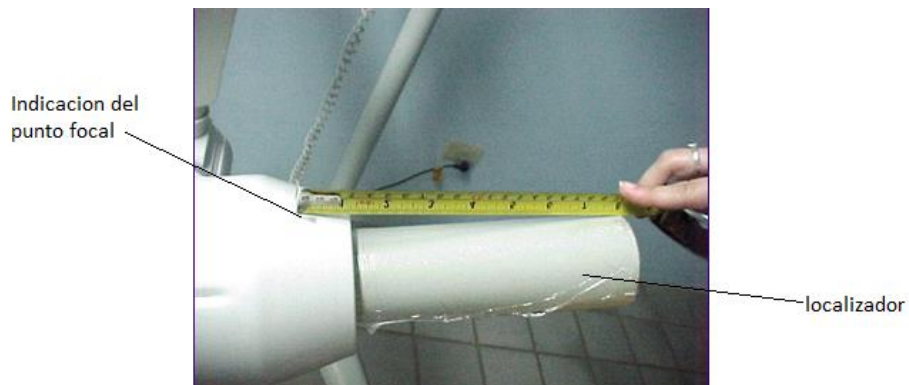
FIG.16. Imagen del procedimiento de medición de la distancia del punto focal a la salida del cono.
