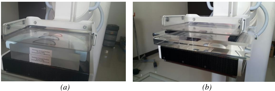
Fuente: colección de los autores FIG. 35. (a) Láminas de PMMA semicirculares con espaciadores (poliestireno expandido) (b) Láminas de PMMA rectangulares con espaciadores (espuma gris).
