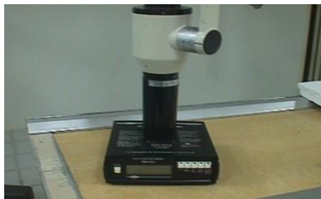
FIG. 19. Imagen del posicionamiento del medidor no invasivo de tiempo de exposición junto con el cono del equipo intraoral.
