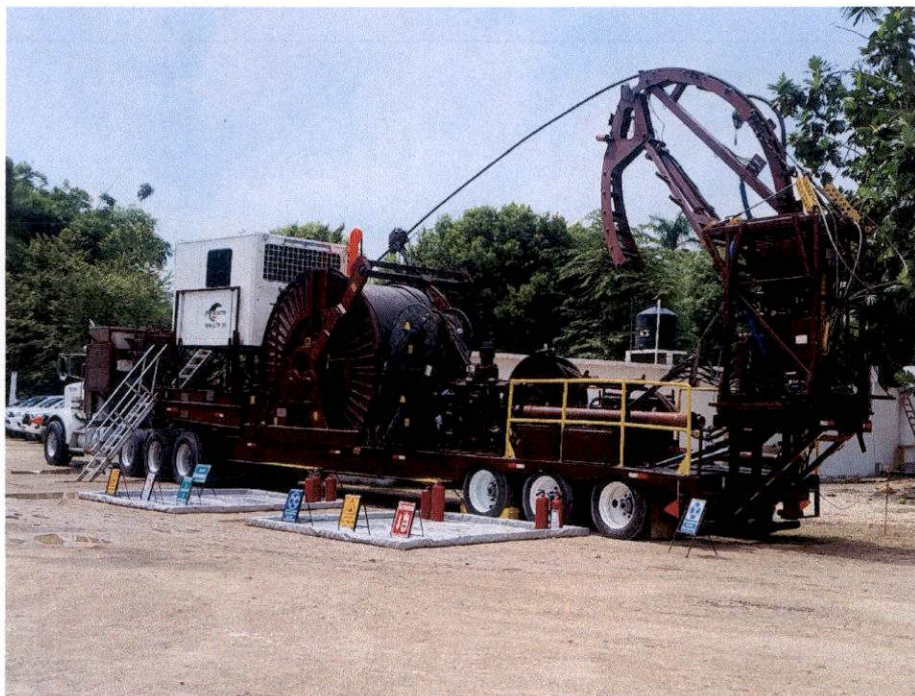
Fotografía 4. Equipo de Coild Tubing
