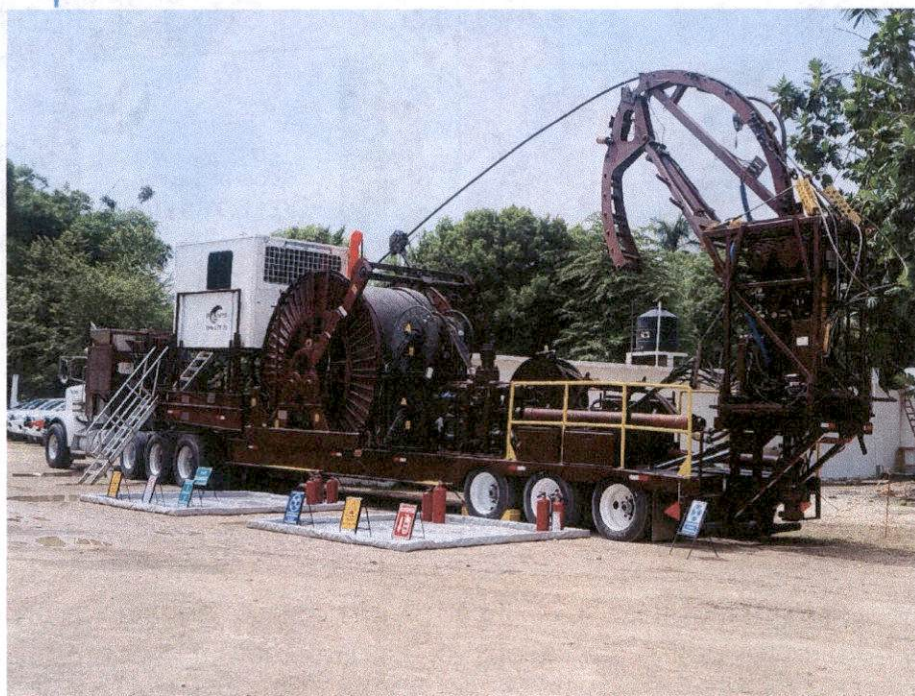
Fotografía 4. Equipo de Coild Tubing
