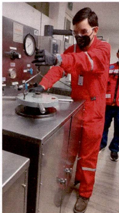
Fotografía 14. Sellando la muestra en el simulador
