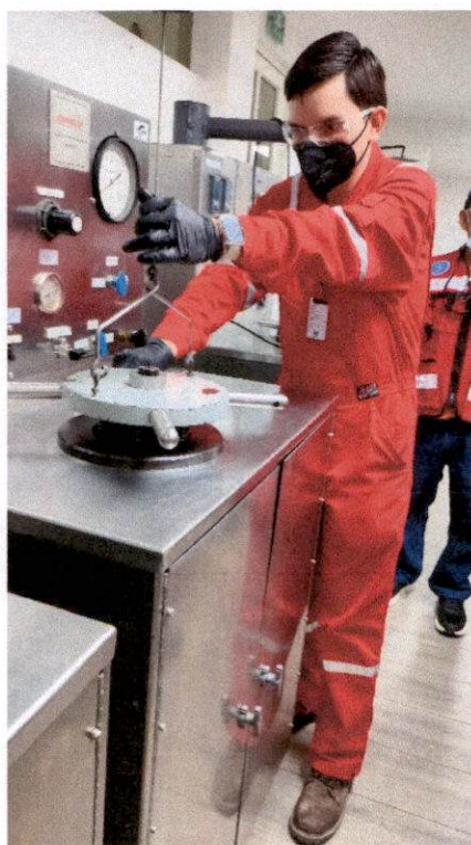
Fotografía 14. Sellando la muestra en el simulador
