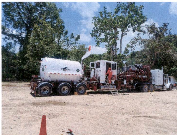
Fotografía 6. Unidad de inyección de nitrógeno.
