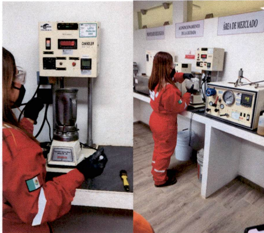
Fotografía 11. Pruebas Reológicas del Cemento
