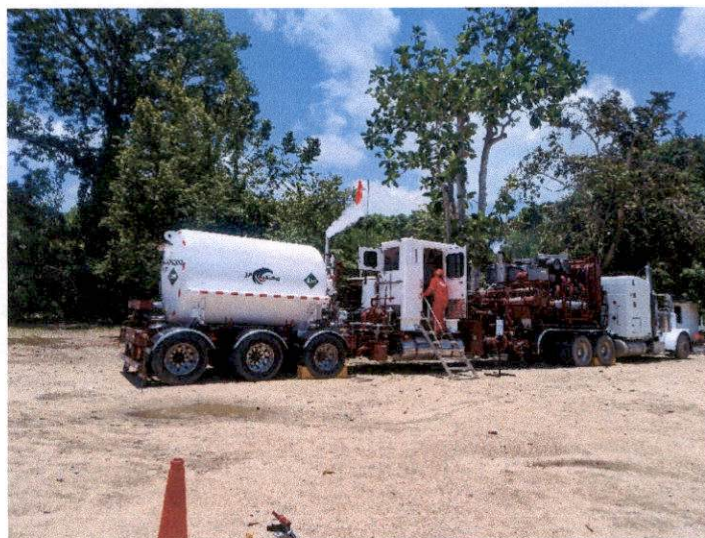
Fotografía 6. Unidad de inyección de nitrógeno.
