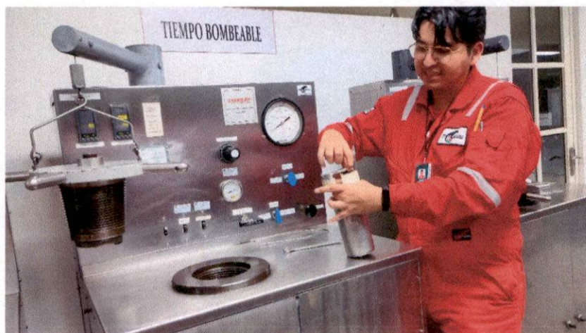
Fotografía 12. Preparando la muestra para el Simulador de Cemento
