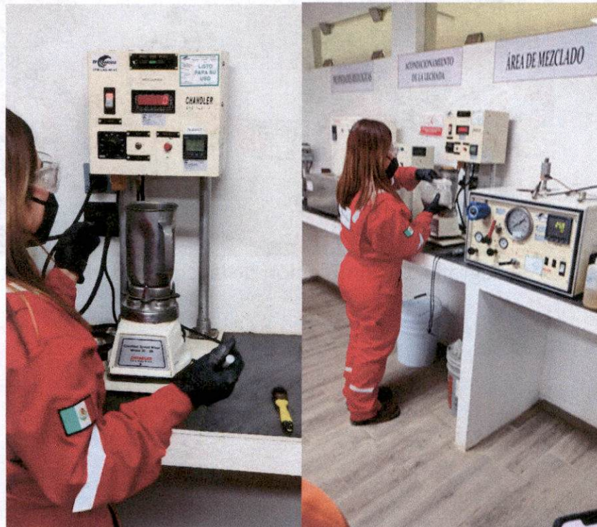
Fotografía 11. Pruebas Reológicas del Cemento
